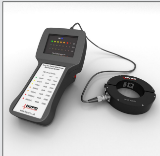
PDSurveyor med TEV, HFCT og ultralydsensor
