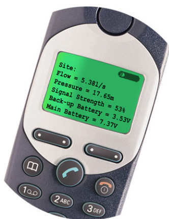
Alarm og aktuelt data nivå kan sendes til mobiltelefon.
